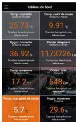
Une appli sur smartphone permet aux gestionnaires de la ville de suivre les consommations de la commune, de suivre les différents capteurs et de recevoir des alertes.
